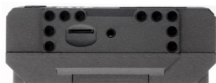
Slot pro Micro SD kartu a audio výstup (jack)
