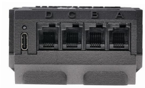
Výstupní motorové porty (A, B, C, D), USB-C konektor a stavová LED pro nabíjení
